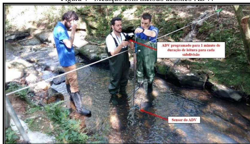
Figura 4 - Medição com método acústico ADV.
