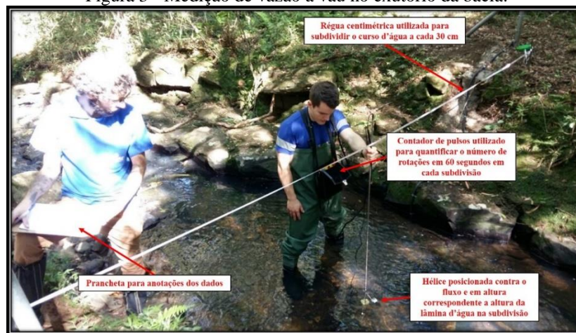
Figura 3 - Medição de vazão a vau no exutório da bacia.
