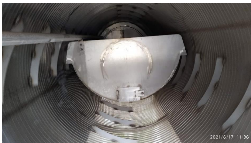
Figura 3: Vista do interior da Peneira com tambor rotativo de fluxo interno. Fonte: Acervo do autor.
