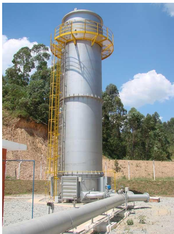
Figura 10: Flare de chama enclausurada fabricado e fornecido pela Brasprocess. Fonte: Catálogo técnico Brasprocess.
