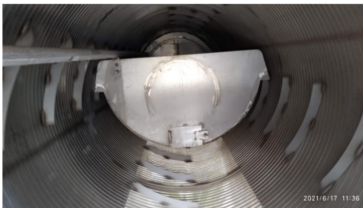
Figura 2: Vista do interior da Peneira com tambor rotativo de fluxo interno. Fonte: Acervo do autor.
