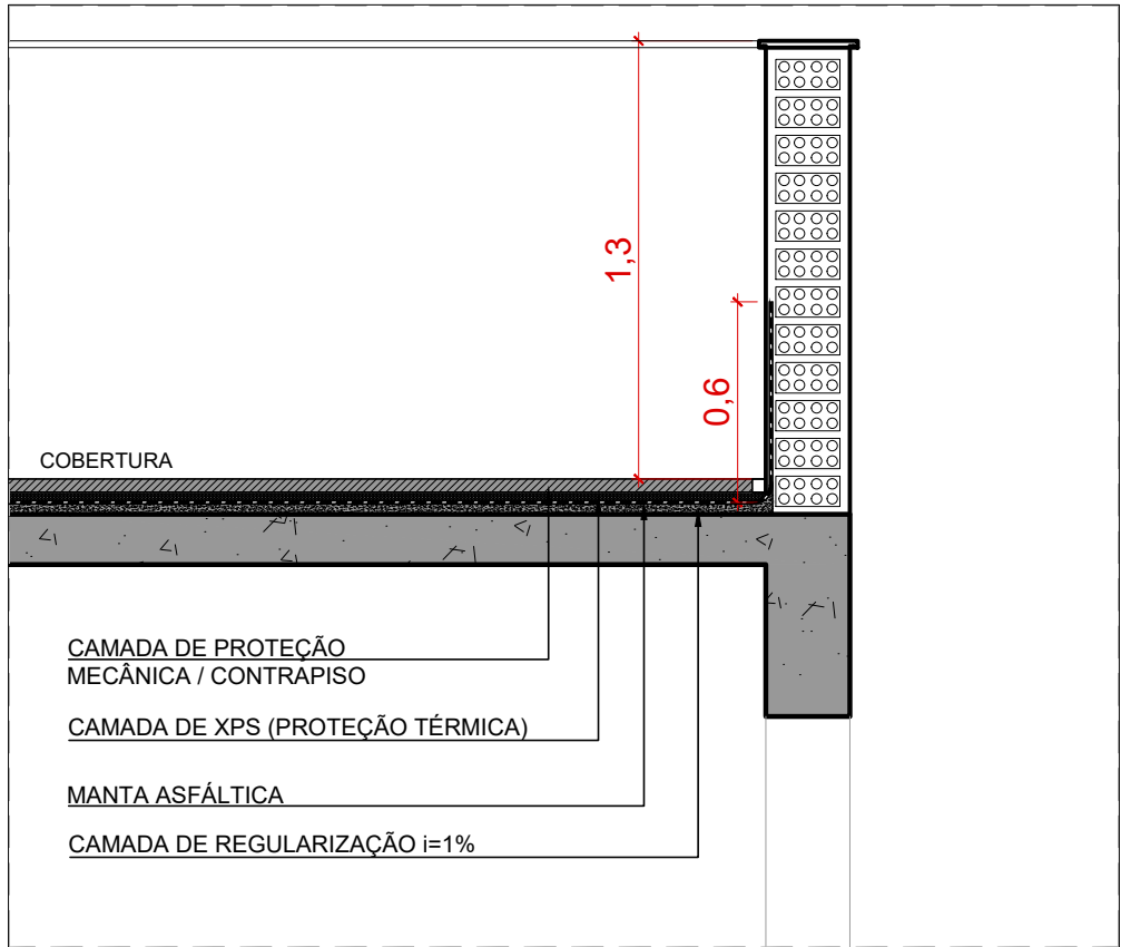
DET 5 - IMPERMEABILIZAÇÃO COBERTURAS ESC.: 1/25
