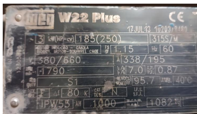
Figura 15 – Placa de um dos três motores
