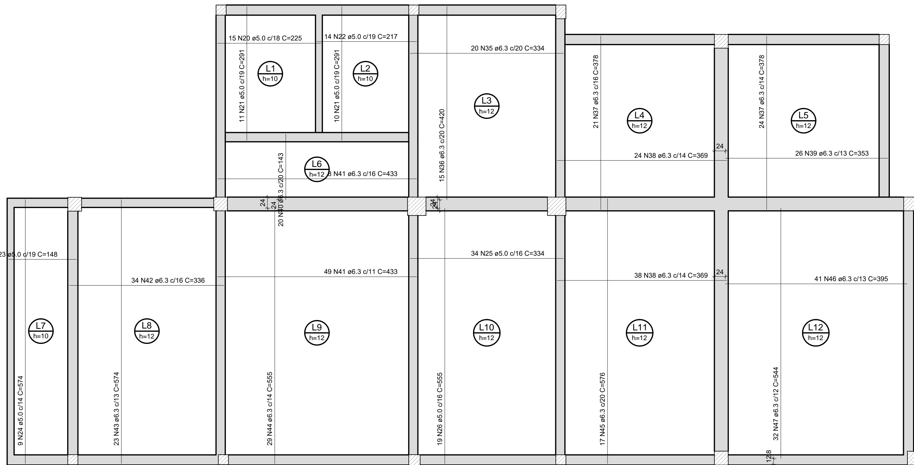
Armação positiva das lajes do pavimento Entrepiso
